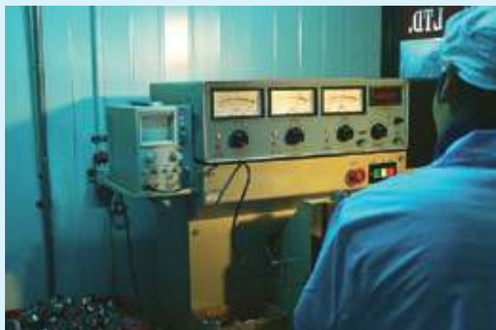
BVT振动（速度）测试 Prueba de vibración (velocidad) por BVT
